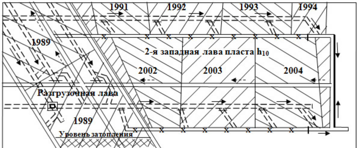
Рис. 1 – Схема горных выработок 2-й западной лавы пласта h_{10} шахты им. М. И. Калинина
