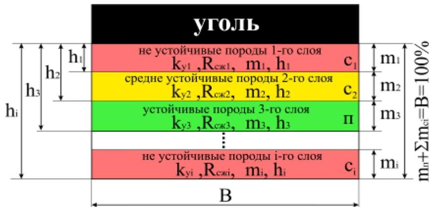
Рис. 1 – Породный массив в почве выработки шириной  $B$ , где:  $k_{yi}$  – критерий устойчивости пород  $i$ -го слоя;  $R_{сжi}$  – сопротивление сжатию пород  $i$ -го слоя;  $m_i$  – толщина пород  $i$ -го слоя;  $h_i$  – глубина залегания пород  $i$ -го слоя;  $\Pi$  и  $C_i$  – прочный слой и кол-во  $i$ -х слабых слоёв в почве
