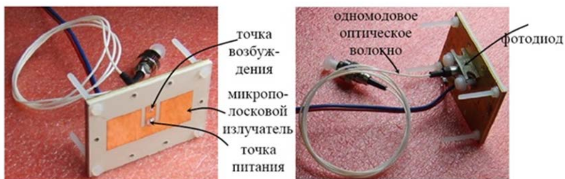
Рисунок 3 – Вид спереди и сзади интегрированной фотонной антенны
