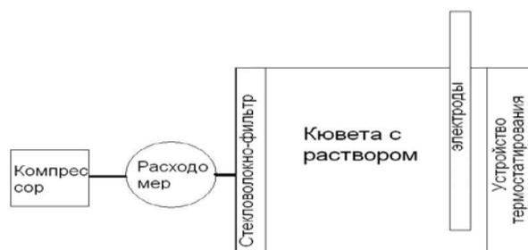
Рисунок 3 – Устройство подготовки пробы
