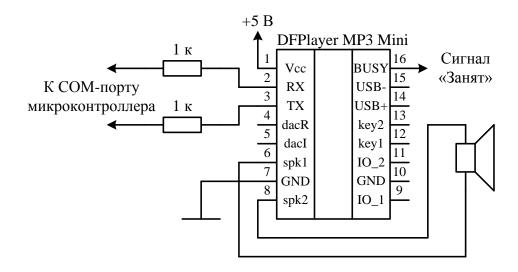
Pucyнок 1 – Схема включения голосового модуля DFPlayer MP3 Mini
