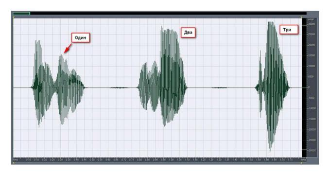
Рисунок 3 – Вид оцифрованных фраз в аудио редакторе Cool Edit Pro
