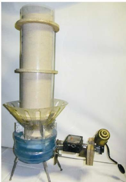
Рис. 3. Физическая модель разработанной системы выгрузки изввести из шахтной обжиговой печи
