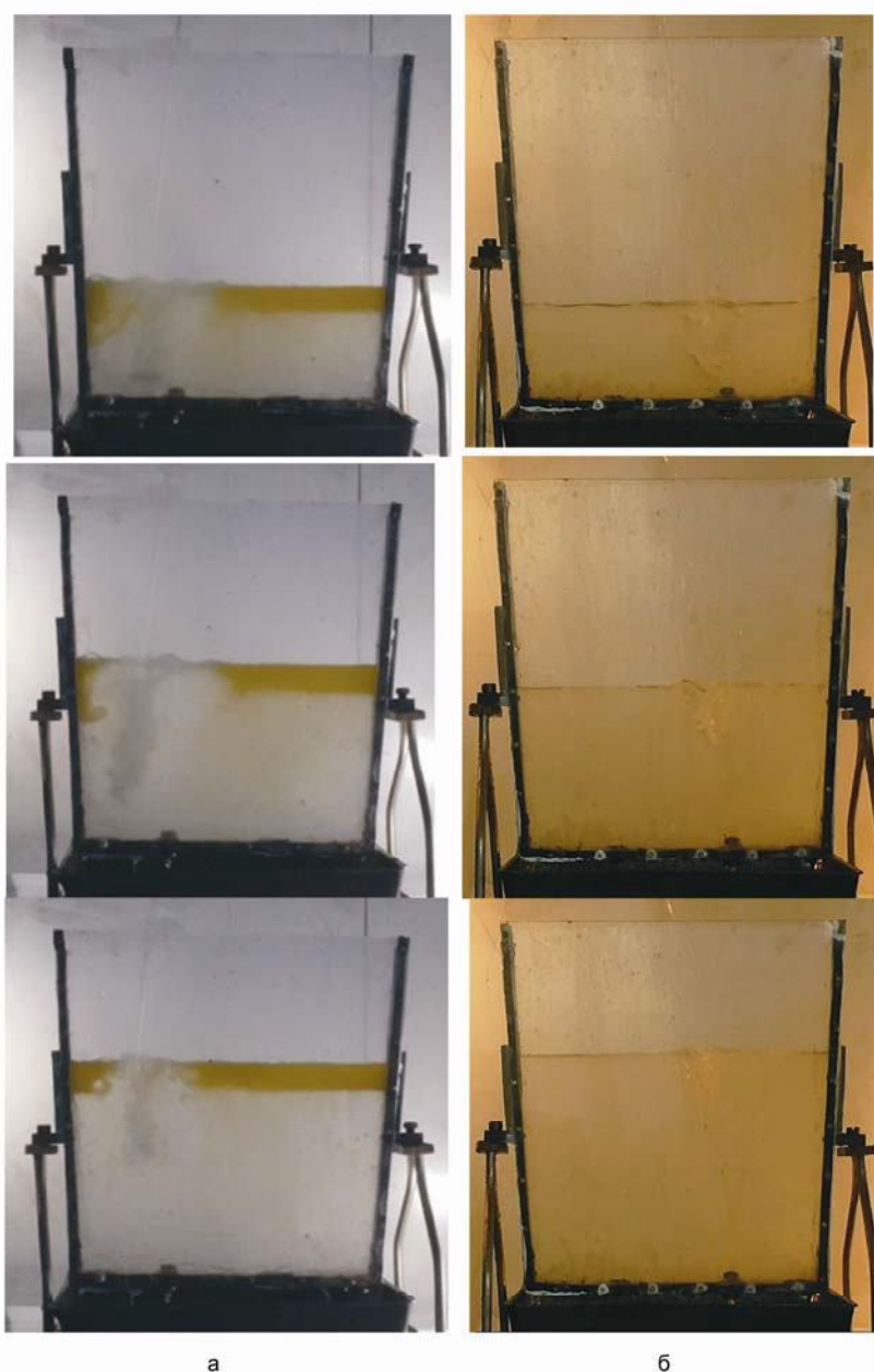
Рис. 8. Распределение слоя имитатора шлакового расплава в модели разливочного ковша при симуляции выпуска стали без удержания (а) и с газодинамической отсечкой (б) конечного шлака
