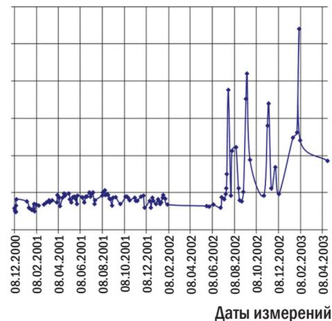
Рис. 3. Общий вид и тренд вибрации винтового компрессора
