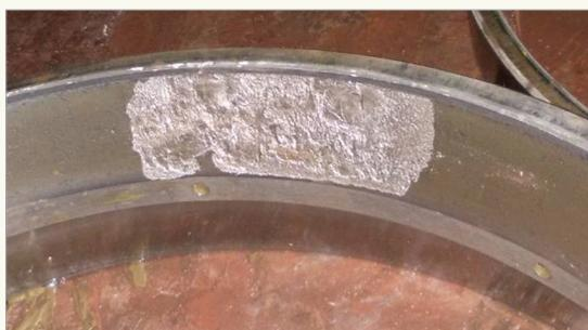
Осповидное выкрашивание в ограниченном секторе наружного кольца по одному ряду — местная нагрузка и действие осевой силы
