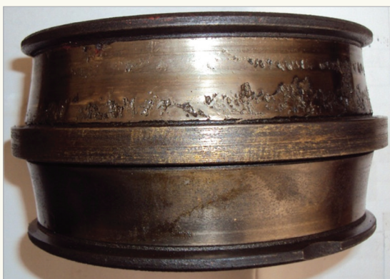
Неравномерное нагружение рядов подшипника
