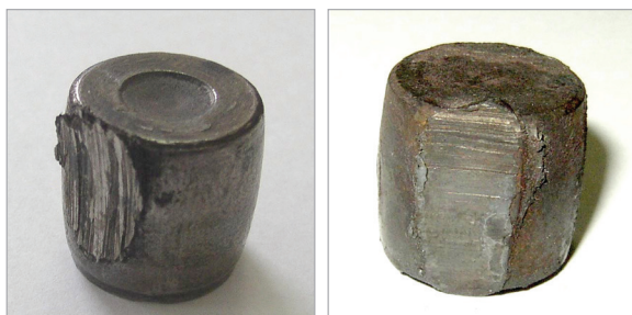
Рис. 7. Характер разрушения тел качения подшипника
