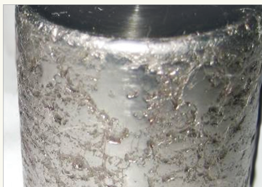
Осповидное выкрашивание ролика
