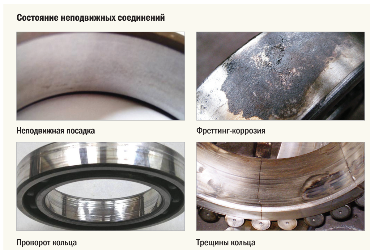
Рис. 1. Визуальное проявление состояния подшипников качения
