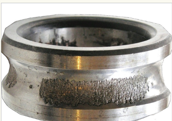
Осповидное выкрашивание при дисбалансе
