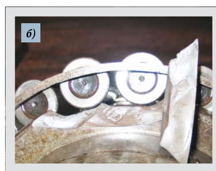
Рис. 19. Поперечная трещина на кольце подшипника (а) и сколы бортов кольца (б) при воздействии ударной нагрузки
