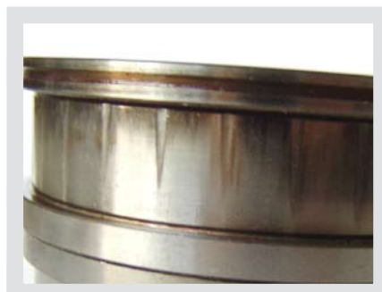
Рис. 18. Треугольная форма контакта кольца с роликом при перекосе вала относительно корпуса двухрядного роликового радиального подшипника
