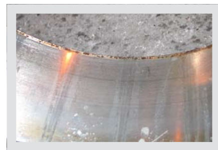
Рис. 24. Следы ложного бринеллирования на рабочей поверхности наружного кольца роликового радиально-упорного конического однорядного подшипника
