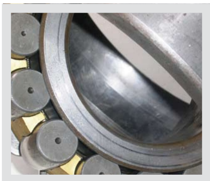
Рис. 17. Кольцевые риски на торцевой поверхности внутреннего кольца — результат контакта кольца подшипника с неподвижной деталью
