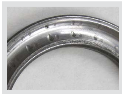
Рис. 23. Бринеллирование на беговых дорожках упорного шарикоподшипника — вмятины с шагом равным шагу тел качения
