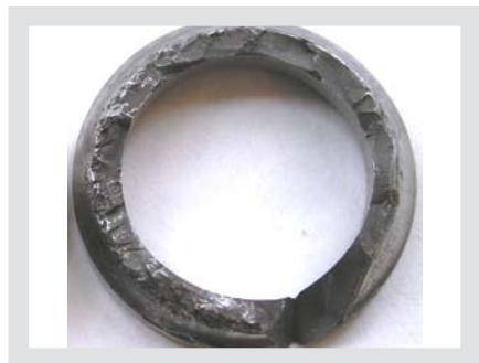
Рис. 21. Разрушение внешнего кольца шарикоподшипника при отсутствии теплового зазора
