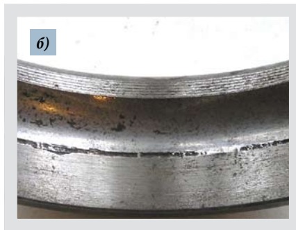
Рис. 22. Гранность (а), осповидное выкрашивание (б) на нерабочей части беговой дорожки радиально-упорного шарикового подшипника при увеличенной осевой игре и продольном нагружении
