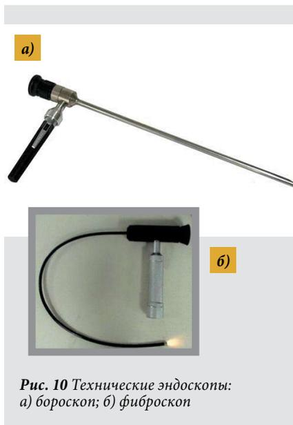
Рис. 10 Технические эндоскопы: а) бороскоп; б) фиброскоп
