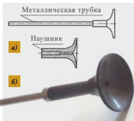
**Рис. 1. Технический стетоскоп**
