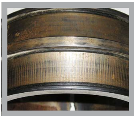
Рис. 6. Следы прохождения электрического тока на наружном кольце двухрядного сферического радиального роликоподшипника
