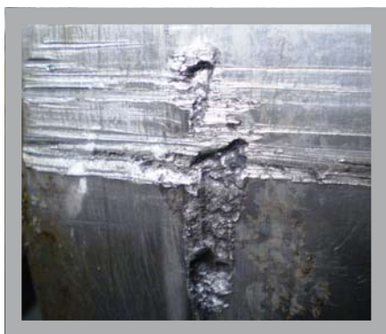
Рис. 1. Износ схватыванием первого рода двух стальных деталей
