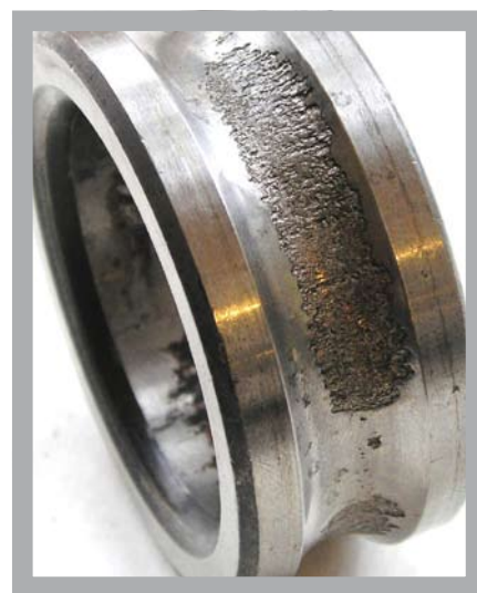
Рис. 11. Местное выкрашивание внутреннего кольца шарикоподшипника при вращающейся радиальной силе и неподвижном наружном кольце и одновременном воздействии осевой силы
