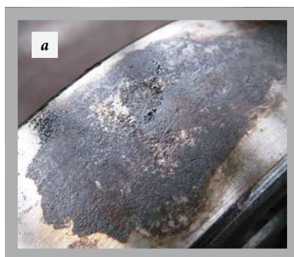
Рис.16. Неравномерное выкрашивание по длине роликов (а) радиального роликоподшипника и беговым дорожкам (б) двухрядного радиального сферического шарикоподшипника при изгибе вала
