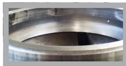
Рис. 9. Осповидное выкрашивание в двух местах на беговой дорожке наружного кольца двухрядного сферического радиального роликоподшипника при отклонении формы посадочного места крышки подшипника
