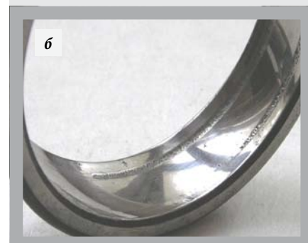
Рис.16. Неравномерное выкрашивание по длине роликов (а) радиального роликоподшипника и беговым дорожкам (б) двухрядного радиального сферического шарикоподшипника при изгибе вала
