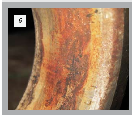
Рис. 15. Следы фреттинг-коррозии на посадочной поверхности наружного (а) и внутреннего (б) колец шарикоподшипника
