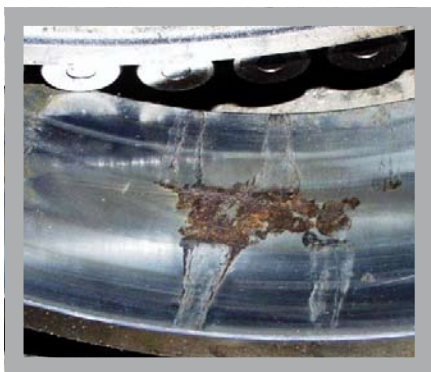
Рис. 7. Следы местной коррозии наружного кольца подшипника
