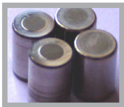
Рис.12. Высветления на торцах роликов одной из беговых дорожек двухрядного радиального роликоподшипника при воздействии осевой силы
