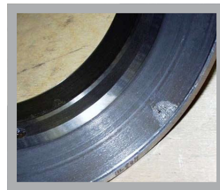
Рис. 5. Абразивный износ на беговой дорожке наружного кольца радиально-упорного конического двухрядного роликоподшипника
