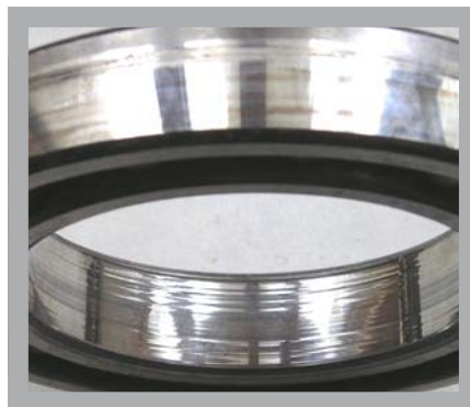
Рис. 14. Следы проворачивания колец подшипника
