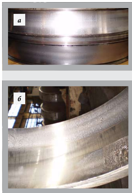
Рис. 8. Следы радиальной силы, постоянной по направлению: а) непрерывный след износа на внутреннем кольце; б) местное изнашивание наружного кольца
