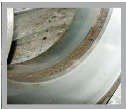
Рис. 2. Окислительный износ на беговой дорожке наружного кольца радиально-упорного конического двухрядного роликоподшипника
