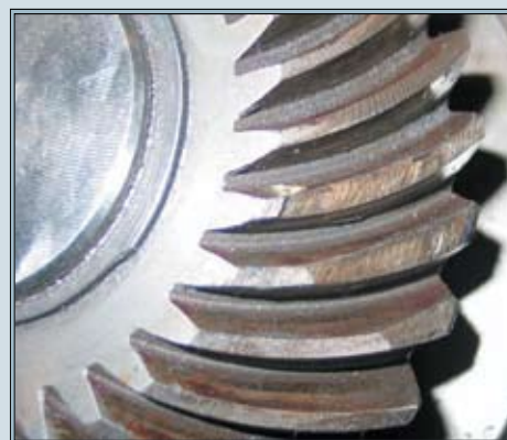
Рис. 18. Повреждения конического колеса при выходе зубьев из зацепления
