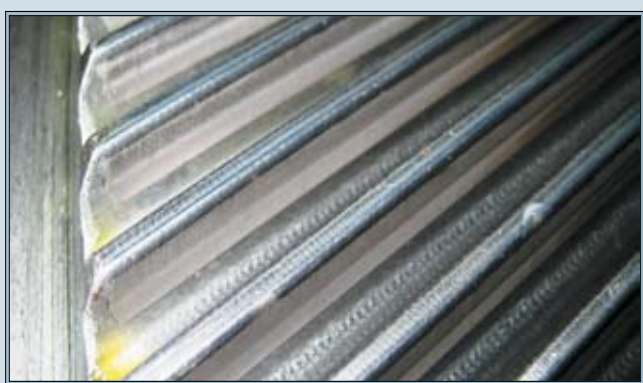
Рис. 11. Окислительный износ поверхности зубчатой передачи при жидкостном трении
