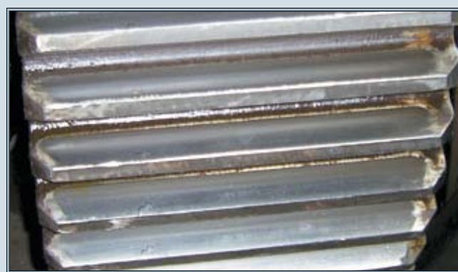
Рис. 14. Равномерное расположение пятна контакта по длине и высоте зуба
