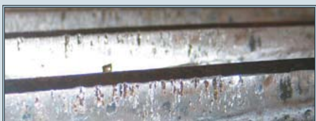
Рис. 13. Вырывы металла на вершинах зубьев — схватывание поверхности при отсутствии разделительной масляной пленки
