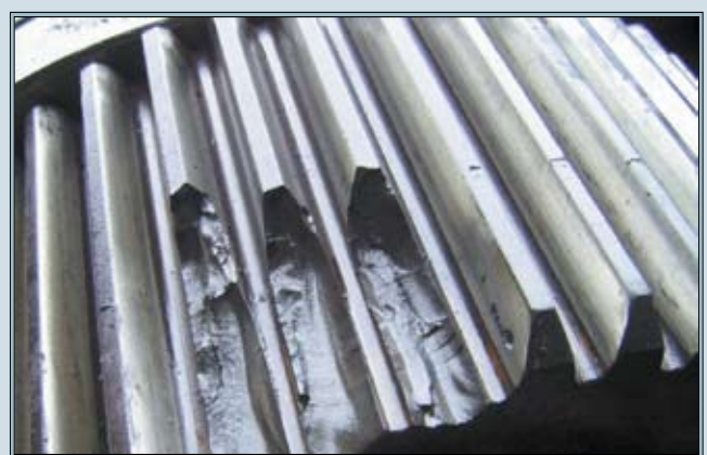
Рис. 5. Излом зубьев из-за воздействия динамических ударов
