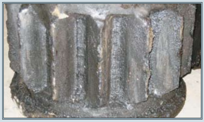
Рис. 9. Предельная стадия абразивного износа кремальерной шестерни
