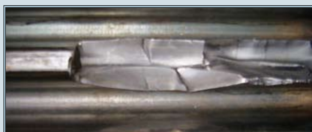
Рис. 19. Локальные разрушения зубьев из-за реализации усталостных трещин
