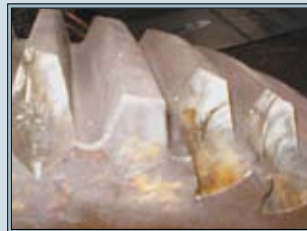
Рис. 19. Локальные разрушения зубьев из-за реализации усталостных трещин
