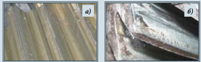
Рис. 4. Пластические сдвиги на рабочей поверхности зубчатой передачи — напряжения на площадках контактов превысили предел текучести
