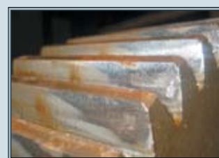
Рис. 15. Сокращение пятна контакта из-за непараллельного расположения осей зацепления при уменьшенном расстоянии между осями зубчатых колес
