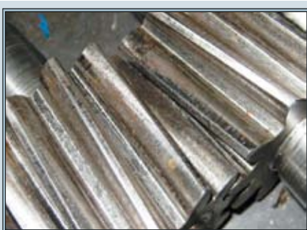
Рис. 8. Начальная стадия абразивного износа колеса шестеренного насоса — появление рисок на рабочей поверхности зубьев
