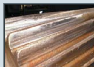
Рис. 17. Неравномерное распределение действующих сил по длине зуба и равномерное распределение по окружности зубчатого колеса
