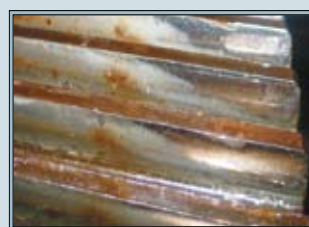
Рис. 15. Сокращение пятна контакта из-за непараллельного расположения осей зацепления при уменьшенном расстоянии между осями зубчатых колес
