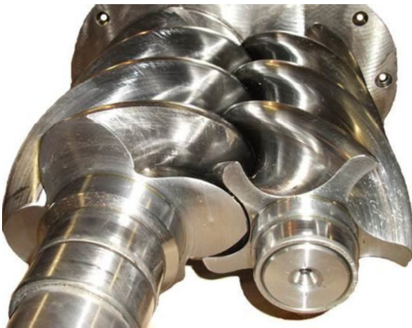
Рис. 2. Рабочий орган винтового компрессора – винты
