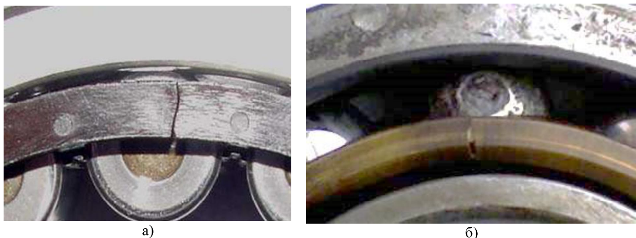
Рис. 4. Осмотр подшипника: а) трещина сепаратора; б) повреждение тела качения
