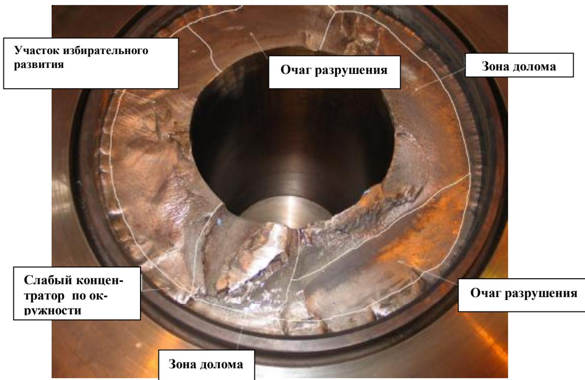
Рис. 2. Структура поверхности излома вала
