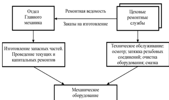
Рис. 1. Взаимодействие цеховых ремонтных служб и подразделений отдела Главного механика при смешанной форме структуры ремонтной службы металлургического предприятия
