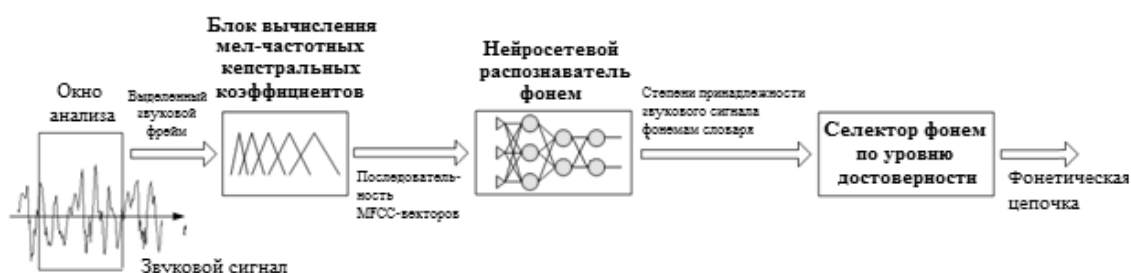
Рисунок 3 – Структура системы распознавания фонем устной речи на основе одиночного нейросетевого распознавателя
