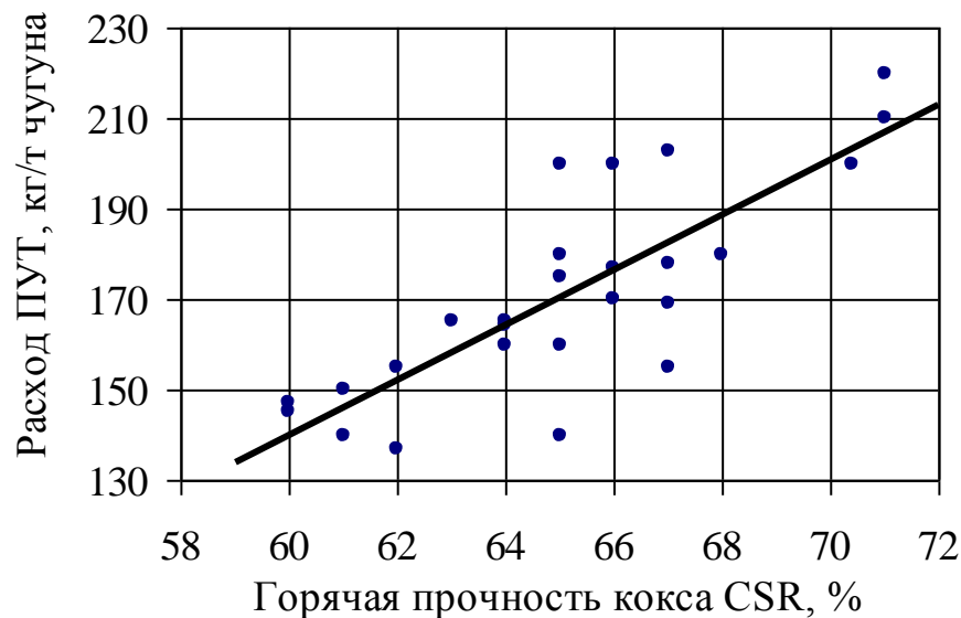
Рисунок 2 - Зависимость удельного расхода ПУТ от горячей прочности кокса: точки - экспериментальные значения по данным работы [12]
