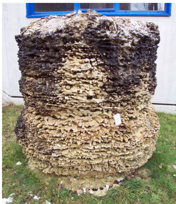
Рис.4.3. Вид отвердевшей смеси цемента и грунта.
