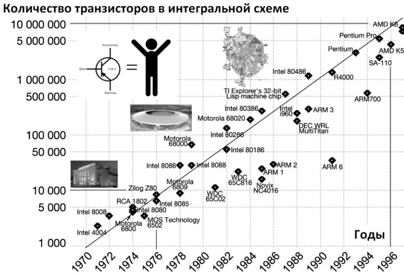
Рисунок 1.37 — Классический закон Мура в период с 1970-го по 1996 год: удвоение количества транзисторов в интегральной микросхеме каждые 18 месяцев или рост на 3 порядка каждые 20 лет (слева сверху показаны эквивалентные по масштабам объекты при условии приравнивания одного человека к одному активному электронному элементу: театр, стадион и город Москва)
