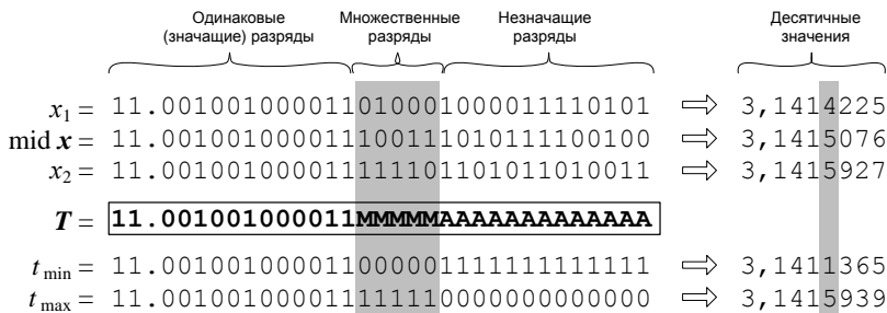
Рисунок 2.13 — Кодирование интервала x тетракодом T с последующим получением границ t_{\min}, t_{\max} результирующего интервала
