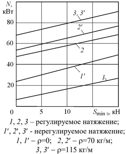
Рисунок 3. Зависимости мощности  $N$  от натяжения  $S_{\min 3}$
