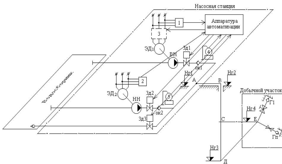
*Рисунок 1 – Технологическая схема насосной станции водоснабжения забоев гидрошахты*
