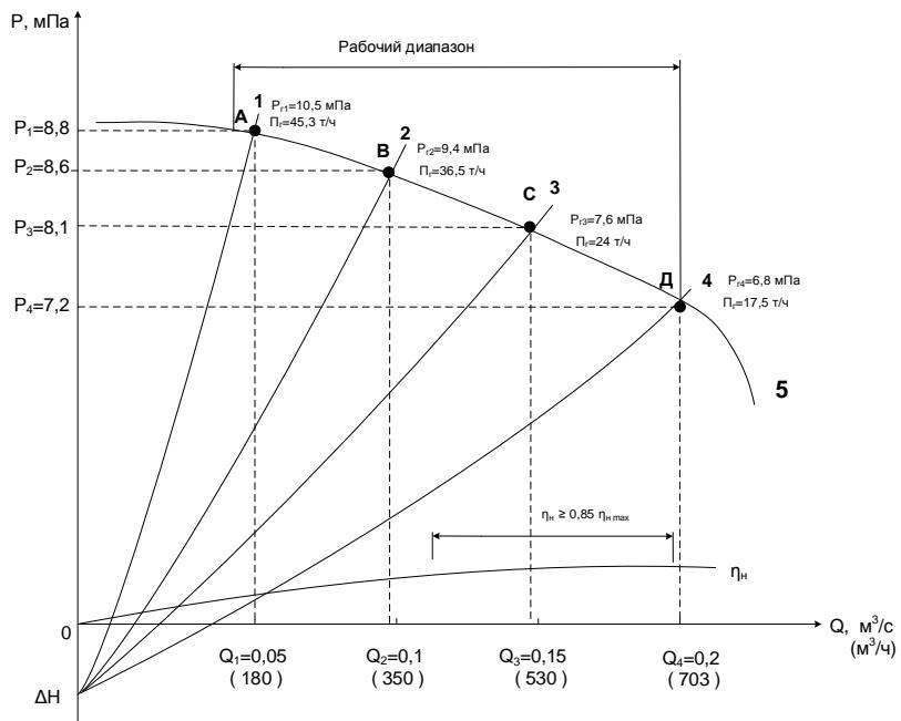
Рисунок 2 – Режимы работы насоса ЦНСГ при водоснабжении забоев
