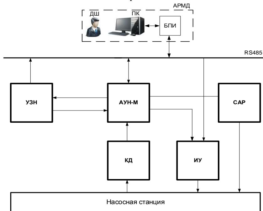
*Рисунок 3 – Структурная схема системы автоматического управления насосной станцией водоснабжения забоев гидрошахты*
