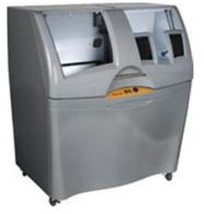
наносится на очередной тонкий (около 0,1 мм) слой порошка, создавая одно сечение объекта. В тех местах, где было нанесено связующее вещество, порошок твердеет. Следующее сечение «склеивается» предыдущим И так далее, пока будет сформировано полностью твердое тело. После окончания работы 3D-принтера изделие извлекается
