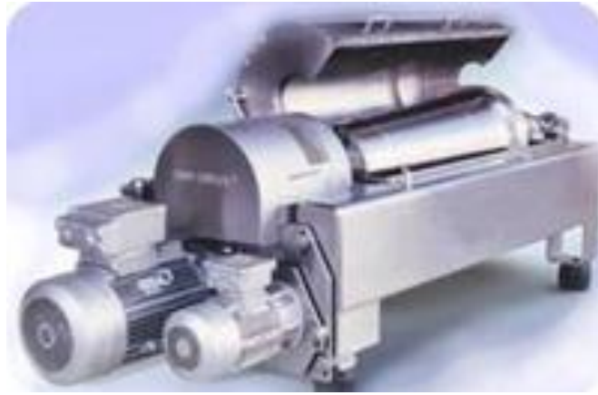
Рисунок 1 – Сепаратор, конструкции ЗАО ПКФ «ПромХим-Сфера»
