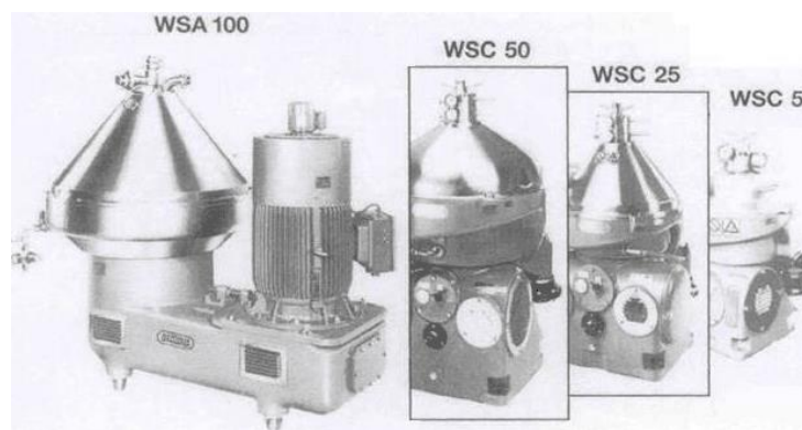
Рисунок 2 – Самоочищающаяся центрифуга тарельчатого типа для разделения нефтяного шлама на фракции
