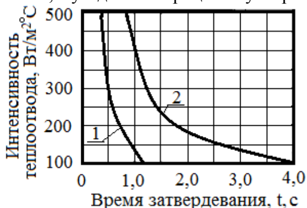
Рисунок 1 – Время затвердевания дроби в зависимости от интенсивности теплообмена в процессе ее полета при частоте вращения 1700 об/мин:
