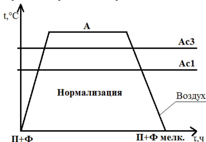
Рисунок 2- Схема термообработки черновых осей
