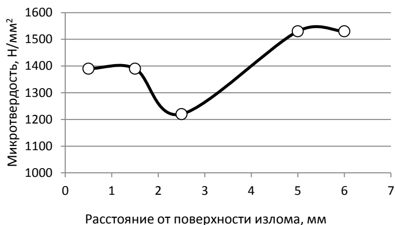
Рисунок 4 – Распределение микротвердости по нормали от поверхности излома
