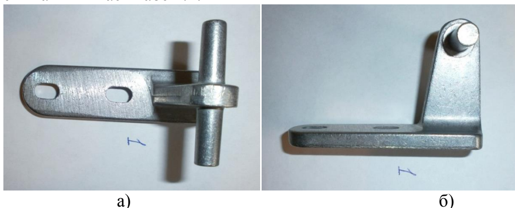
Рисунок 1 – Сложная отливка для холодильного оборудования алюминиевого сплава АК12М2 в литом состоянии (масштаб 1:2): а) вид сверху; б) вид сбоку
