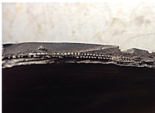
Рисунок 2-Слои металлокорда в шине Т 175/70 R13
