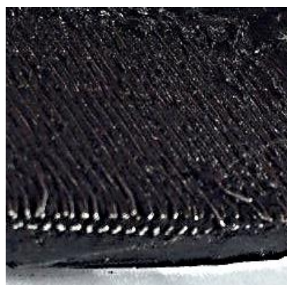
Рисунок 3- Расположение нитей корда в радиальной шине Т 175/70 R13
