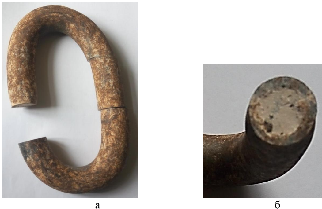
Рисунок 1 – Общий вид разрушенного звена (а) и излом (б)
