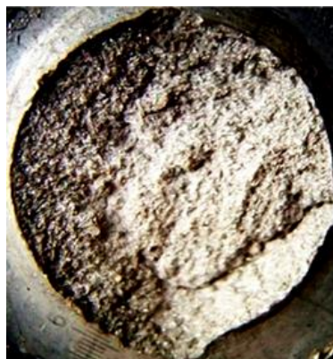
Рисунок 3 – Излом ушка петли после испытания на разрушение \times 16
