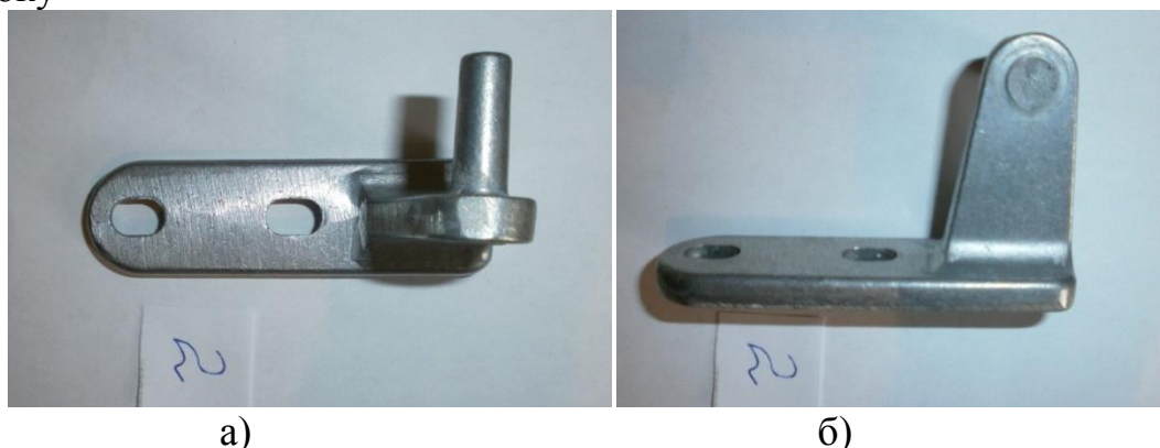
Рисунок 2 – Сложная отливка для холодильного оборудования алюминиевого сплава АК12М2 после испытания на разрушение (масштаб 1:2): а) вид сверху; б) вид сбоку
