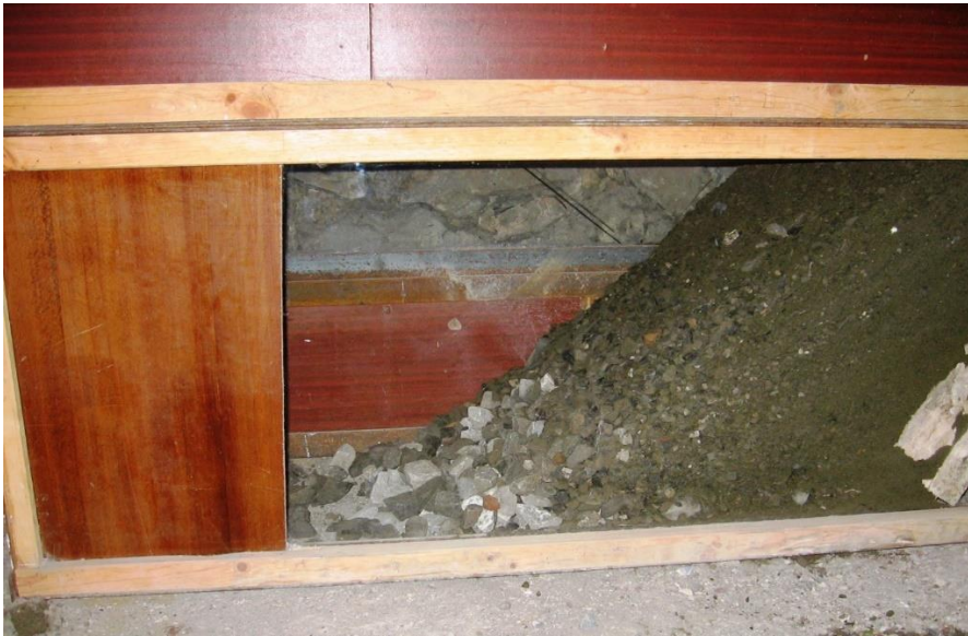
Рисунок 2 – Распределение и плотность укладки сыпучих горных пород в передней части штабеля (вид с боку)
