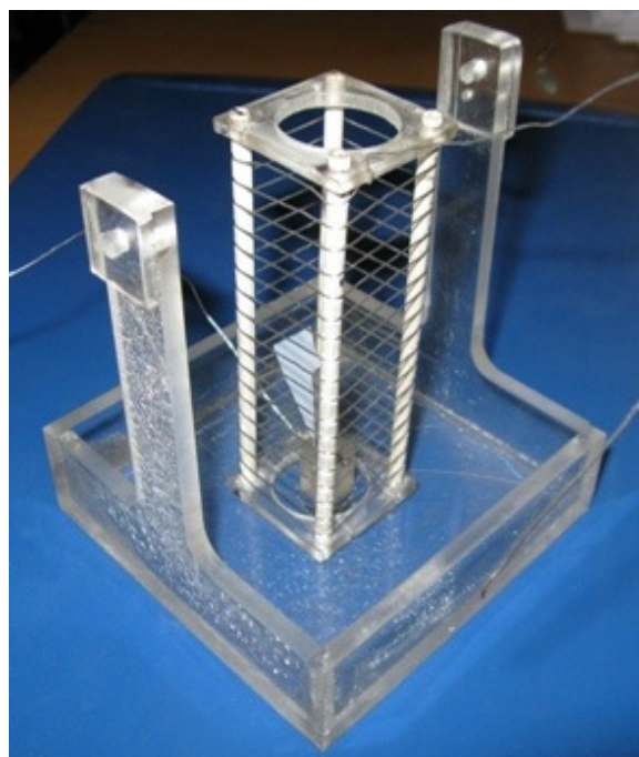
Рис. 2. Блок электрохимического насыщения образцов
