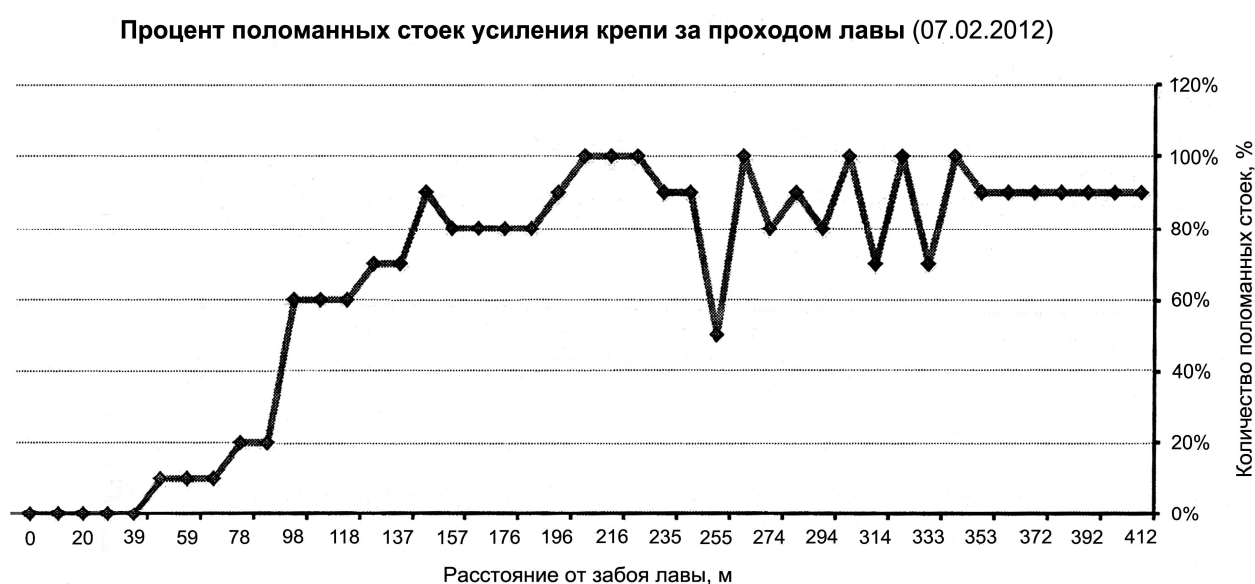
Рис. 4. Состояние деревянных стоек крепи усиления в зависимости от расстояния до лавы (доля в % поломанных стоек)
