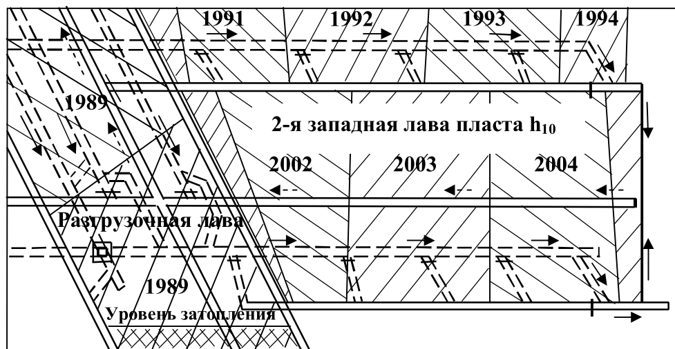
Рис. 1. Схема горных выработок 2-й западной лавы пласта h_{10} шахты им. М.И. Калинина
