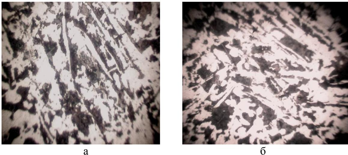
Рисунок 3 - Видманштеттова структура феррита: а – в центре оси; б – в приповерхностном слое, x100
