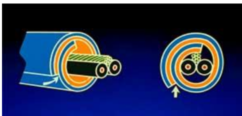
Рисунок 3 – Экранирование на основе сэндвича
