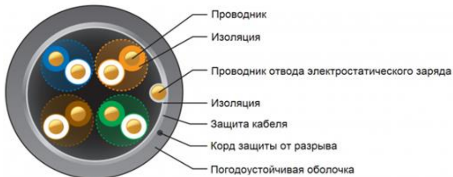
Рисунок 1 – Пример электростатического экранирования
