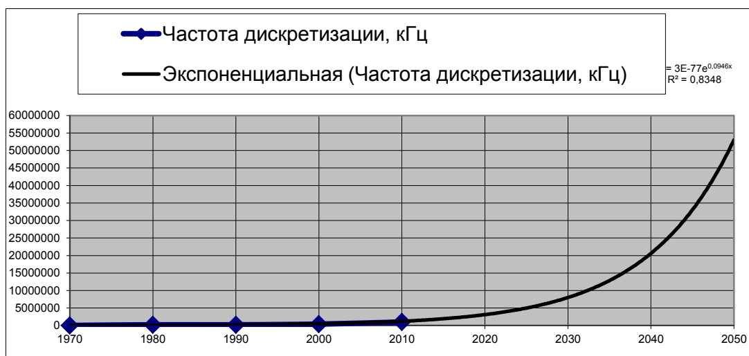
Рисунок 4 – Экстраполяция роста скорости преобразования (частоты дискретизации) АЦП и ЦАП до 2050 года
