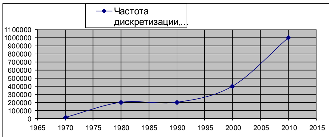
Рисунок 3 – Рост скорости преобразования (частоты дискретизации) АЦП и ЦАП с 1970 по 2010 гг.
