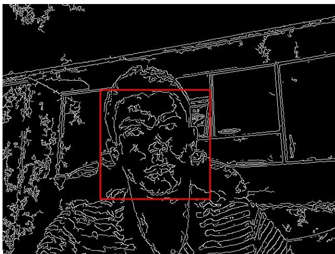
Рисунок 5 - Детектирование лица с помощью OpenCV
