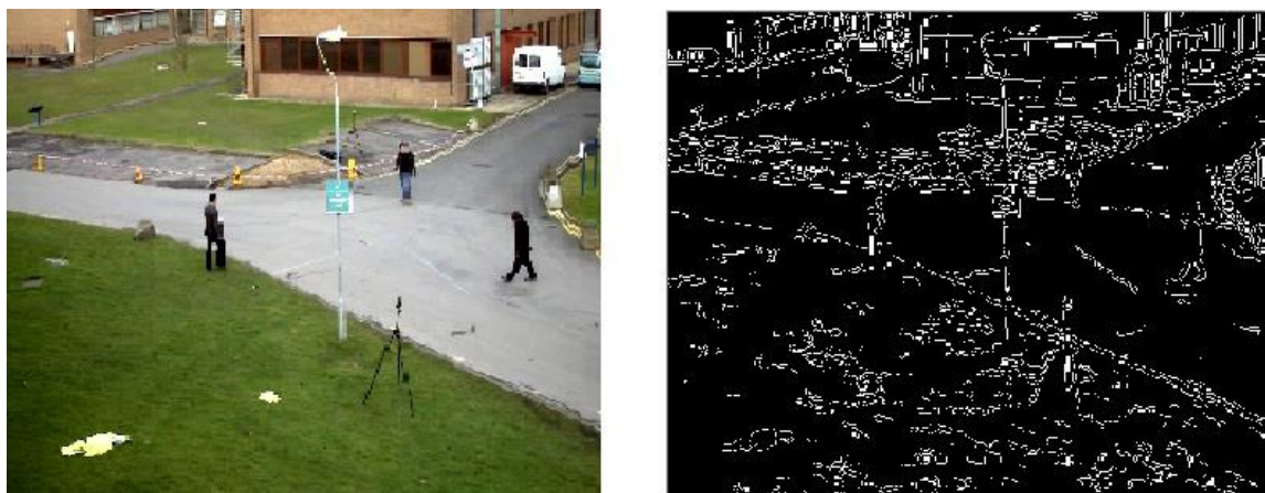
Рисунок 3 - Преобразование рисунка в монохромное с помощью OpenCV
