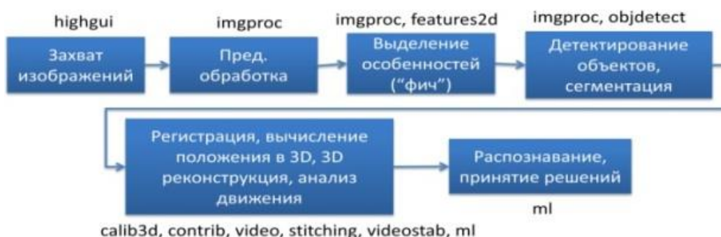
Рисунок 2 - Общая структурная схема приложения на OpenCV
