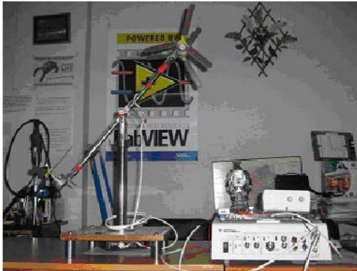
Рисунок 2 – Лабораторный стенд системы управления аэродинамическим объектом
