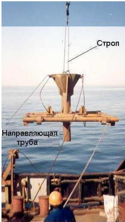
Рис. 3. Вынос опоры за борт судна
