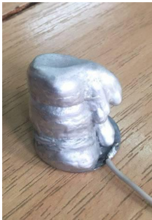
Рисунок 2 – Общий вид лабораторной установки ЭСП (а) и выплавленный на ней слиток из сплава Вуда (б)
