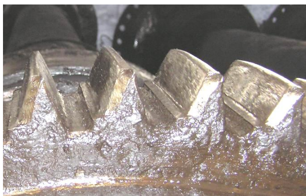
Рисунок 2 – Износ зубьев зубчатых муфт
