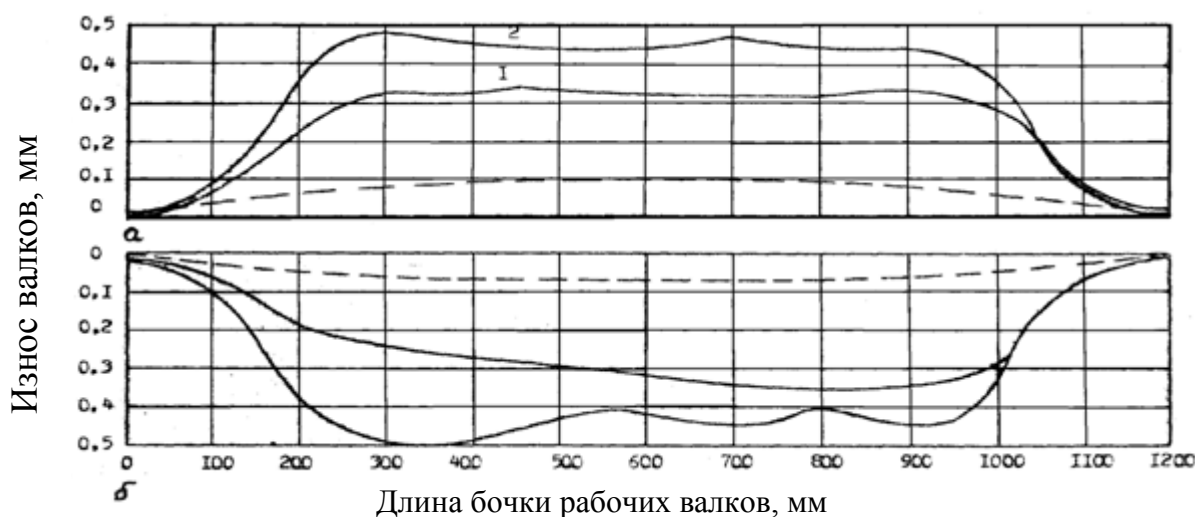
Рисунок 1. Износ верхнего (а) и нижнего (б) рабочих валков чистой клетки стана при горячей прокатке стали с 5% эмульсией А20 (а) и баз смазки (б). Штриховыми линиями показано начальный профиль валков.
