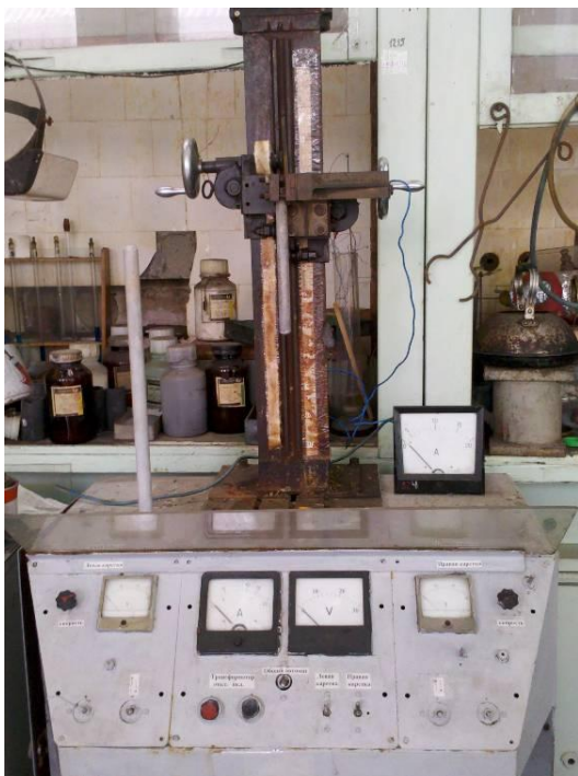
Рисунок 2 – Общий вид лабораторной установки ЭСП (а) и выплавленный на ней слиток из сплава Вуда (б)
