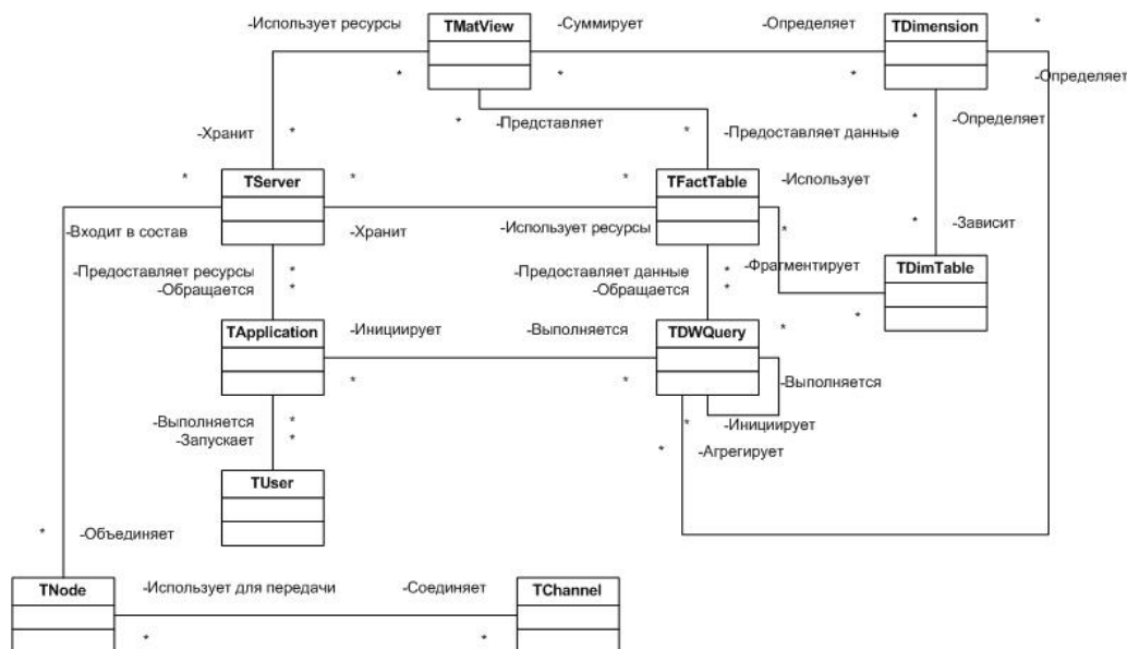
Рисунок 3 – Схема взаимодействия объектных моделей типовых компонентов РХД
