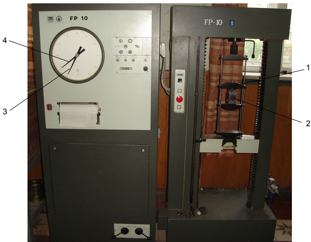
Рис. 3. Общий вид универсальной испытательной машины FP-10: 1– динамометрическое приспособление; 2–приспособление для исследования на срез; 3– рабочая стрелка; 4–фиксирующая стрелка
