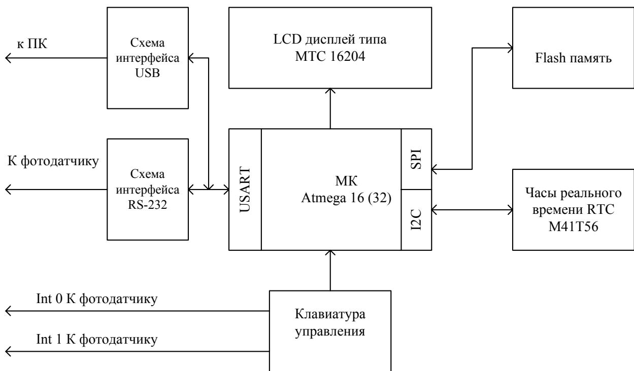
Рис.1 Структурная схема устройства настройки фотодатчика
