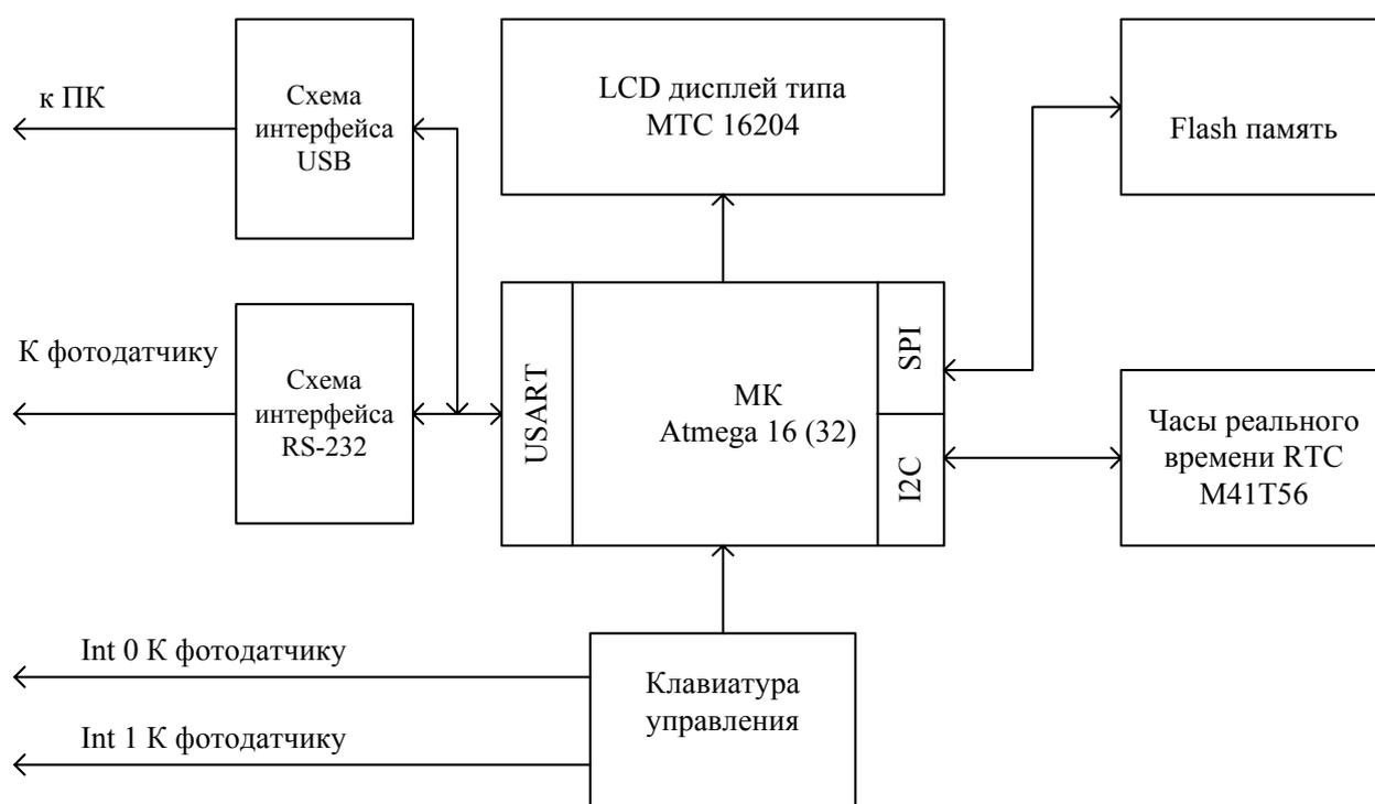
Рис.1 Структурная схема устройства настройки фотодатчика
