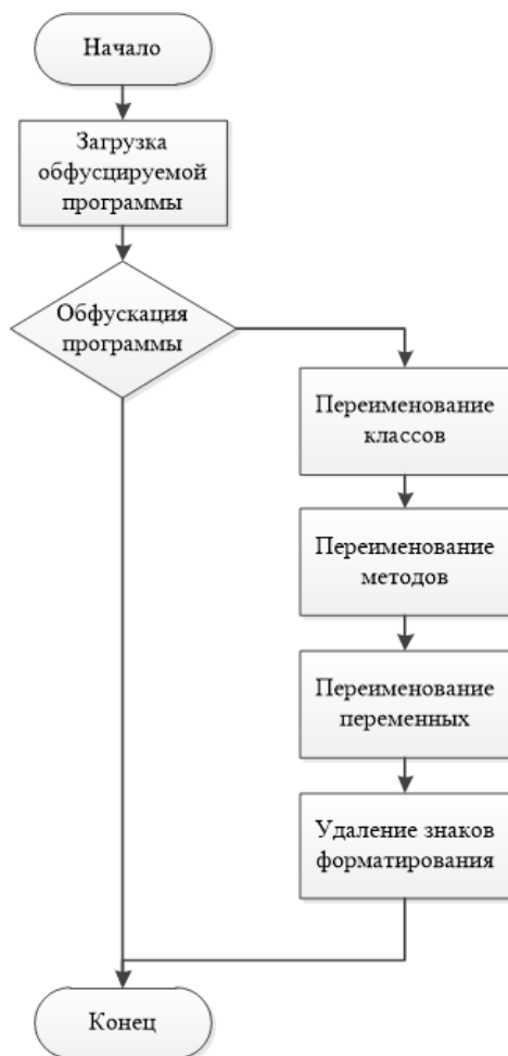
Рисунок 1 – Алгоритм обфускации программы на основе лексического метода обфускации
