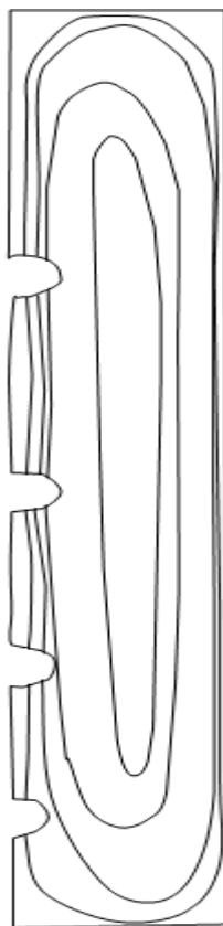
Рис. 5.18. Осесимметричное распределение линий тока в расплаве металла при всплывании пузырей аргона
