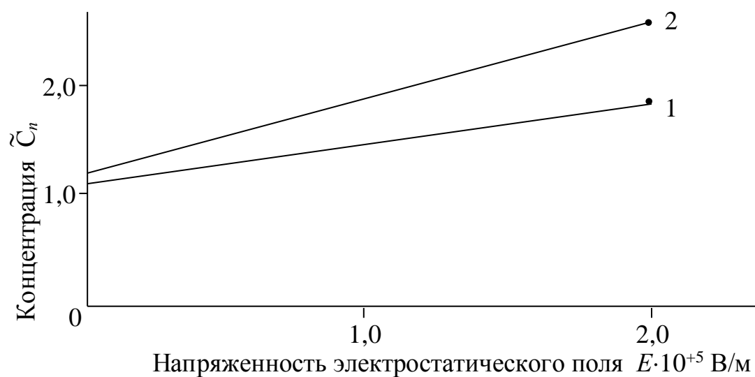
Рис. 5.13. Зависимость максимальной безразмерной концентрации \tilde{C}_n атомов водорода на межфазной поверхности «металл-вакуум» от напряженности электростатического поля: 1 – i=0,5 ; 2 – i=1,0
