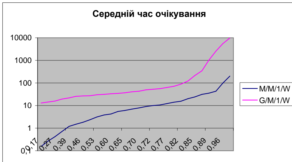
Рисунок 1. – Залежність середнього часу очікування пакету для систем M/G/1/W та M/M/1/W від коефіцієнту використання каналу
