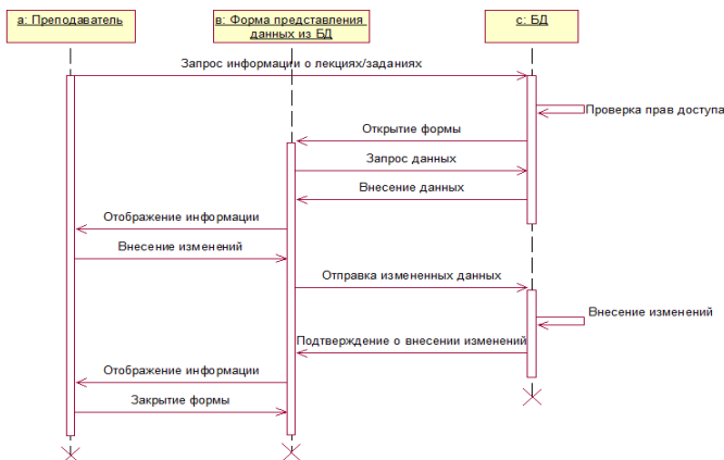
Рисунок 5 – Диаграмма последовательности для вариантов использования «Редактировать тему лекции», «Редактировать тип задания», «Редактировать тему задания»
