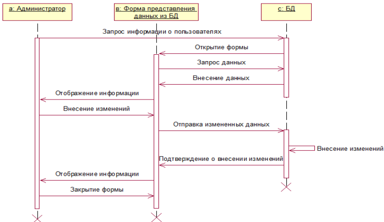
Рисунок 4 – Диаграмма последовательности для варианта использования «Изменить права доступа»
