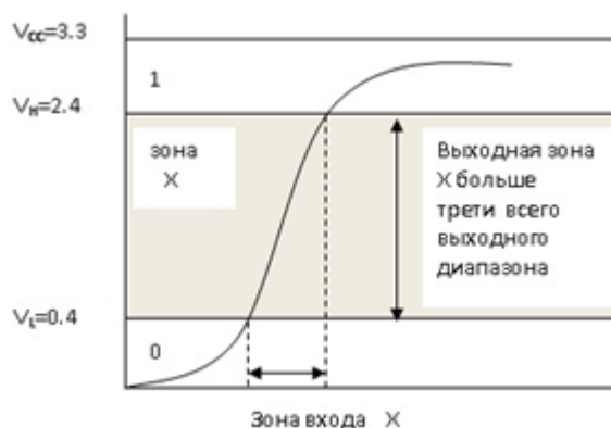
Рисунок 1 – Увеличение диапазона неопределенного значения X при его передаче вентилем.
