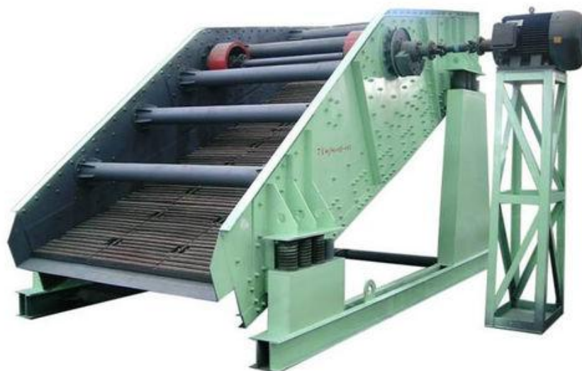
Рис. 1 – Вибрационный грохот инерционного типа с карданной передачей в трансмиссии дебалансного вибровозбудителя
