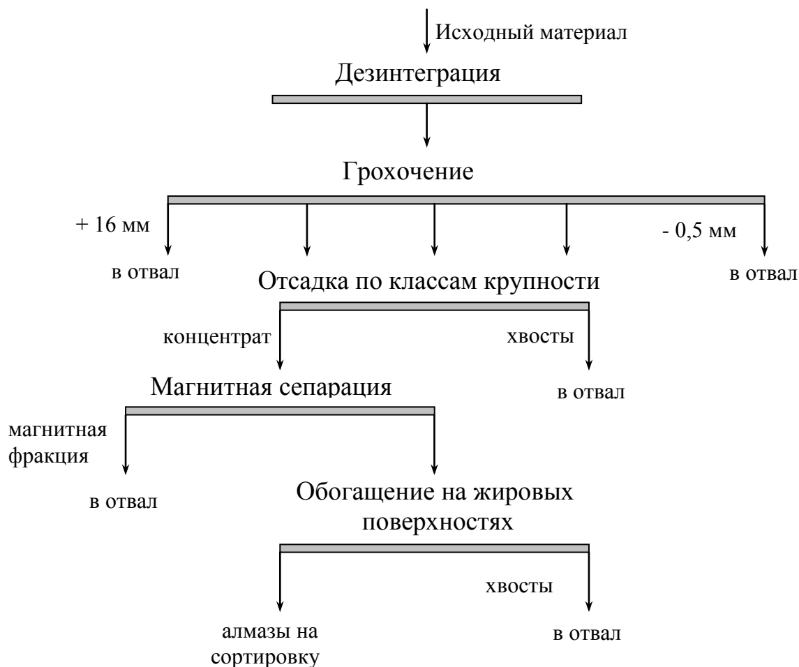
Рис. 9.8. Схема обогащения алмазосодержащих россыпей
