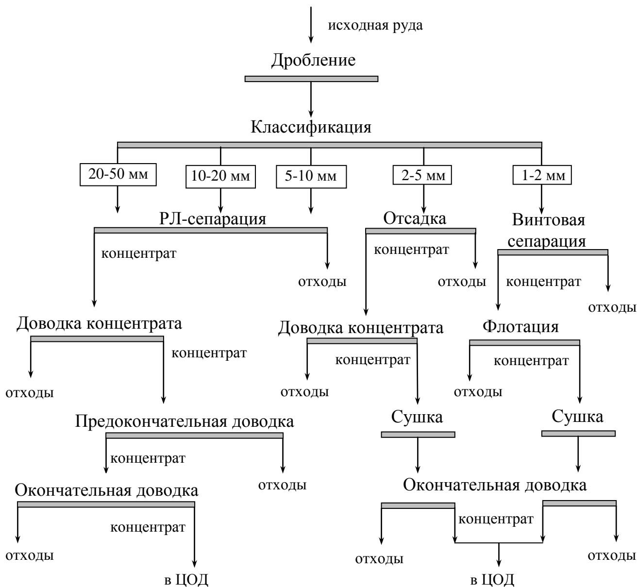
Рис. 5.2. Схема обогащения алмазосодержащих кимберлитовых руд
