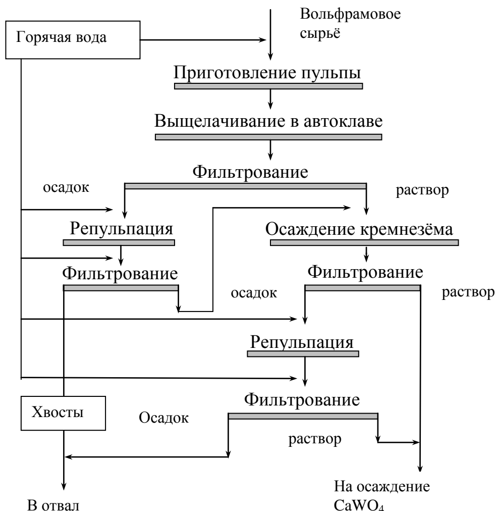
Рис. 20.2. Схема автоклавного выщелачивания вольфрамовых продуктов
