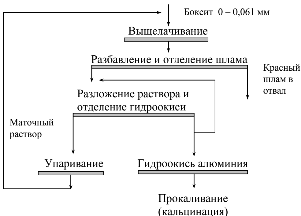
Рис. 20.1. Упрощённая схема получения глинозёма способом Байера
