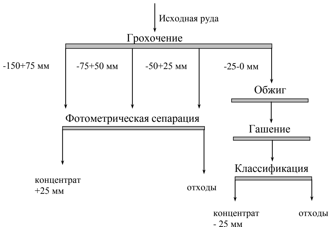
Рис. 13.2. Схема обогащения фосфоритов
