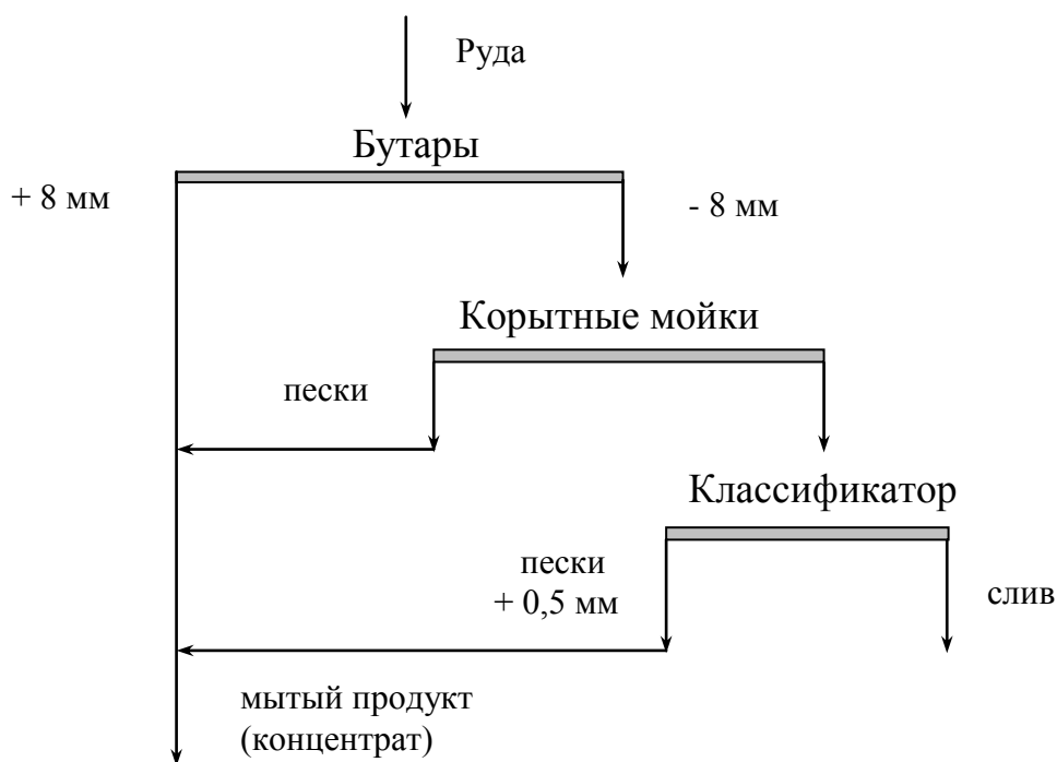
Рис. 12.5. Схема промывки руды на рудомойке № 1 Егорьевского рудника
