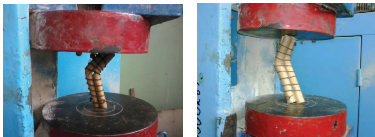
Рис. 3 - Вид разрушения двух и трех деревянных стоек с гибкими стяжками при различной высоте разлома стоек
