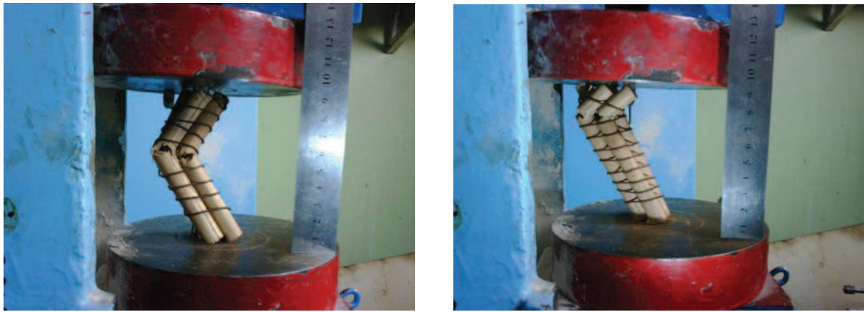
Рис. 4 - Вид разрушения четырех и пяти деревянных стоек с гибкими стяжками при различной высоте разлома стоек
