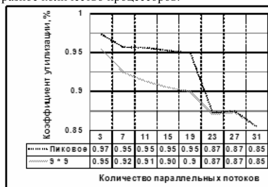
Рисунок 6 – График изменения утилизации вычислительной мощности в параллельной программе в зависимости от числа потоков.
