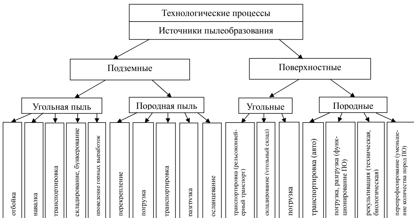
Рис. 1 . Источники пылеобразования при добыче угля и породы
